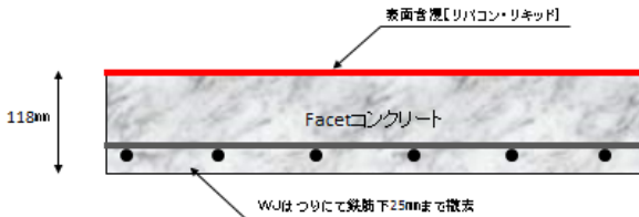
図-3 当初の断面構成
